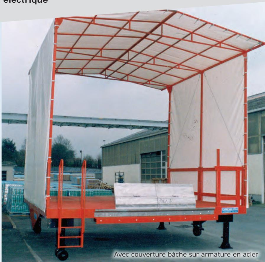
Avec couverture bâche sur armature en acier
