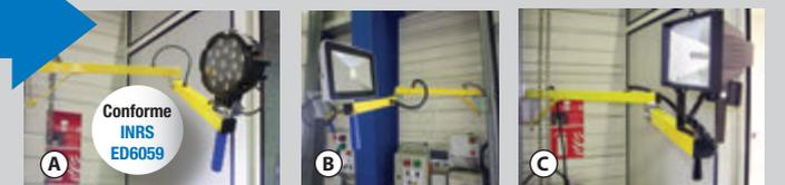
La mise en place d'un éclairage additionnel permet d'éclairer les zones les plus dangereuses et de supprimer les contrastes lumineux nécessitant un temps d'adaptation de la pupille, source potentielle de danger.
